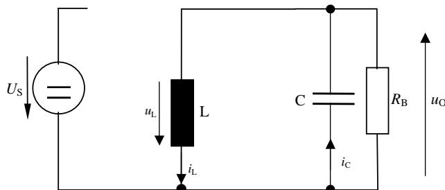
$$\Delta I_L(-) = \frac{U_o}{L} t_{OFF} = \frac{U_o}{L} D_2 T_s \quad t_{OFF} \neq (1-D)T_s$$
